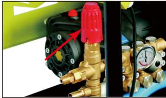
6.接通电源, 试启动主电机, 查看电机旋转方向。确认旋转方向正确后启动设备, 将管路和设备内的空气排出干净。
